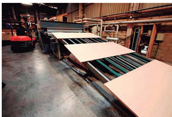
Fig.18. Prensado y encolado. Rechapados del norte. (2021)
