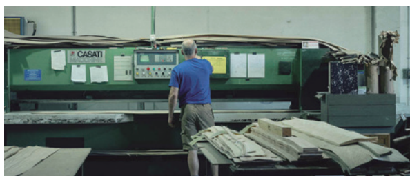
Fig.15. Selección y corte de chapa. Rechapados Ferrer. (2021).
