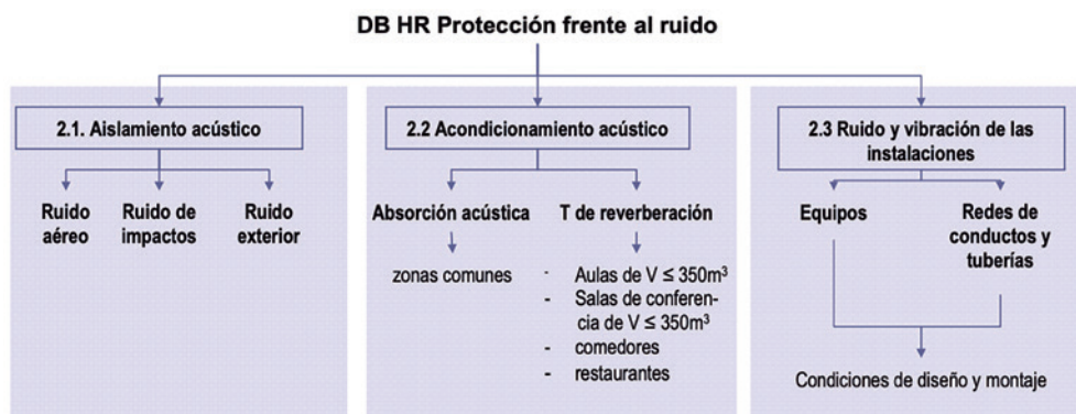
Fig. 05. Criterios de aplicación del DB HR. Guía de aplicación del DB HR. (2016)
