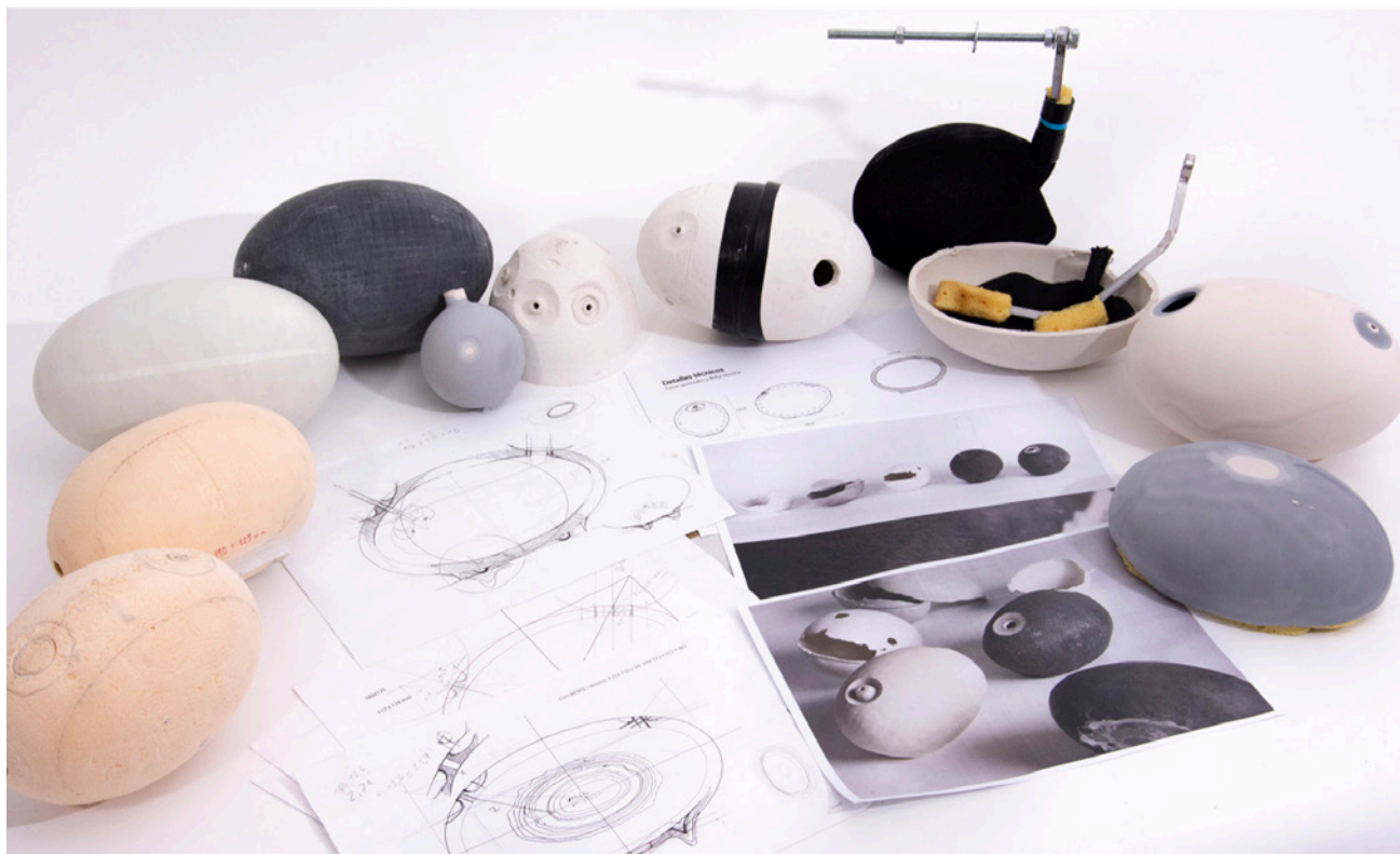
Fig. 06. Proceso: material previo, bocetos y proporciones, primeras volumetrías, modelos impresión 3D, pruebas de material, estudio de la boquilla, sistema de anclaje, acabados finales (Fuente propia, 2021).
