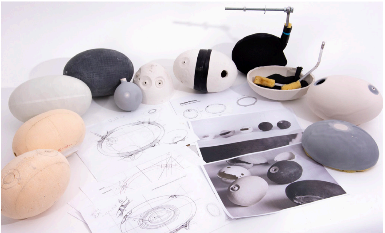
Fig. o6. Proceso: material previo, bocetos y proporciones, primeras volumetrías, modelos impresión 3D, pruebas de material, estudio de la boquilla, sistema de anclaje, acabados finales (Fuente propia, 2021).
