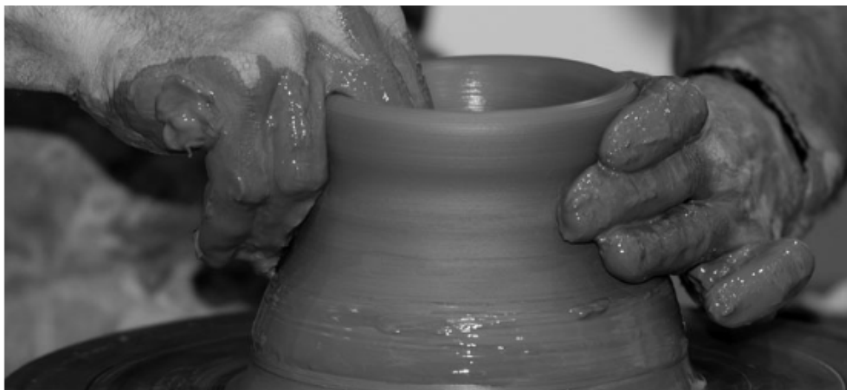
Fig. 02. Artesano cerrando el zurrón de un botijo en el torno. (Antonio Gómez, 2008).
