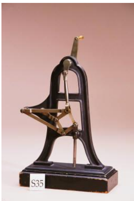
Figura 2: inversor de Peaucellier. Modelo de la Colección Reuleaux. (Fuente: KMODDL)
