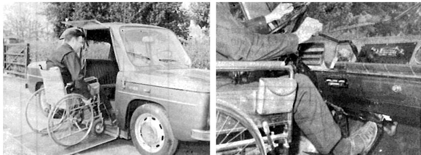
Fig. 11. Carl Habermann muestra las modificaciones realizadas en un Renault 8 de serie para su acceso y conducción. Fotografías publicadas en 1967 en la Toomy J. Gazeete .
