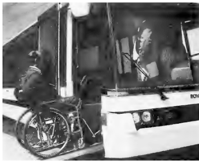
Fig. 4. Prototipo de Tansbus, con sistema de acceso para sillas de ruedas. US Department of Transportation, 1975.
