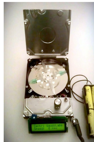
Modelo de centrifuga de tubos de 1.5 mL, fabricado a partir de un disco duro de ordenador desarrollado por Guadí Labs (Lucerna, Suiza) http://hackteria.org/ .
