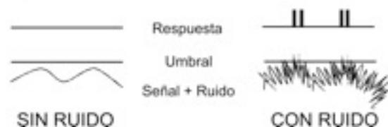
Fig. 2. En ausencia de ruido, una señal periódica portadora de información pasa desapercibida al no superar el umbral de detección (izquierda). Un ruido moderado permite percibir la periodicidad de la señal (derecha).
