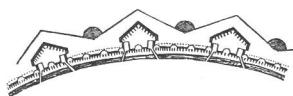
Figura 7. El sistema abaluartado es la fórmula emblemática de la fortificación moderna, adaptándose a todo tipo de perímetros urbanos o plazas modernas. MedinaBarba; p. 68-69, 152 y 160.
